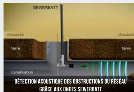
DÉTECTION ACOUSTIQUE DES OBSTRUCTIONS DU RÉSEAU GRÂCE AUX ONDES SEWERBATT
